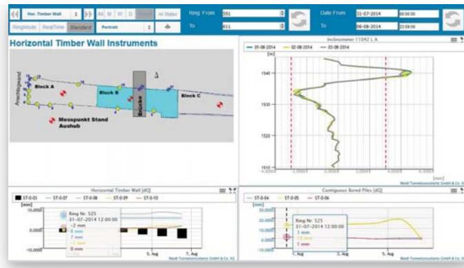
Baugrubenüberwachung ein. Dabei wird die Verteilung der jeweiligen Sensoren an der Baugrube in einer Zeichnung festgehalten, wobei jeder eingetragene Sensor seine interaktiv Sensordaten durch anklicken in einem Popup anzeigen. Zusätzlich zu der Anordnung der Sensoren können zugehörige Diagramme mit Sensordaten auf dem Dashboard platziert werden um einen schnellen Überblick über den gesamten, aktuellen Status zu bekommen.
